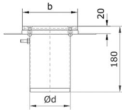
**2-teilige Ausführung** wie Typ ino 364-HF, komplett aus Edelstahl, Werkstoff 1.4301 (V2A), gemäß EN 1253, mit quadratischem Einlaufrand, mit zusätzlichem Deckendurchführungselement mit Pressdichtungselement zum Anschluss einer unteren Dichtungsebene.
