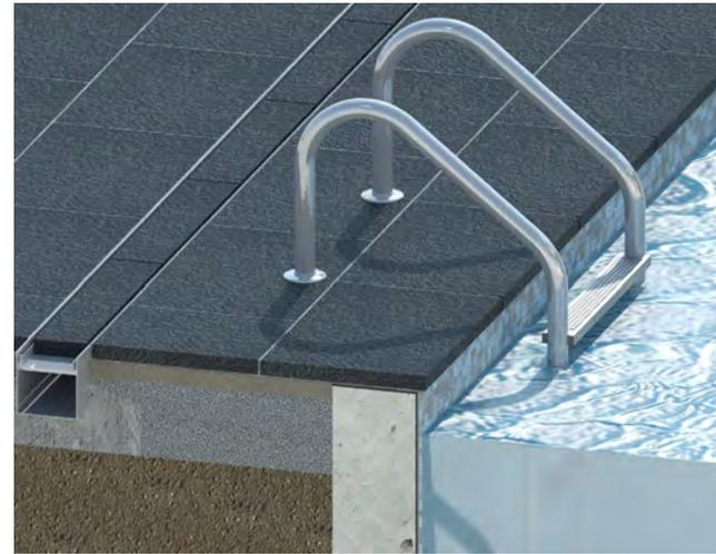
**Kunststoffrost** für **Schwimmbäder** oder **Poolanlagen** mit Sicherheitsprofilprägung für nassbelastete Barfußbereiche. Bewertungsgruppe nach DIN 51097 Klasse B/C geprüft, Größe der Öffnungen nach DIN EN 1253-1 max. 8 mm, Farbauswahl: Weiß, Grau, Gelb oder Beige
