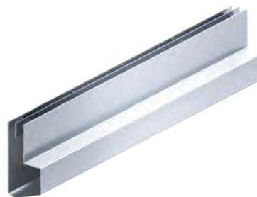
Doppelte Schlitzbreite durch **eingeschweißten Mittelsteg** zur Vergrößerung der Wasseraufnahme und **Bypass-Lösungen** zur Ableitung stark anfallender Wassermengen.
